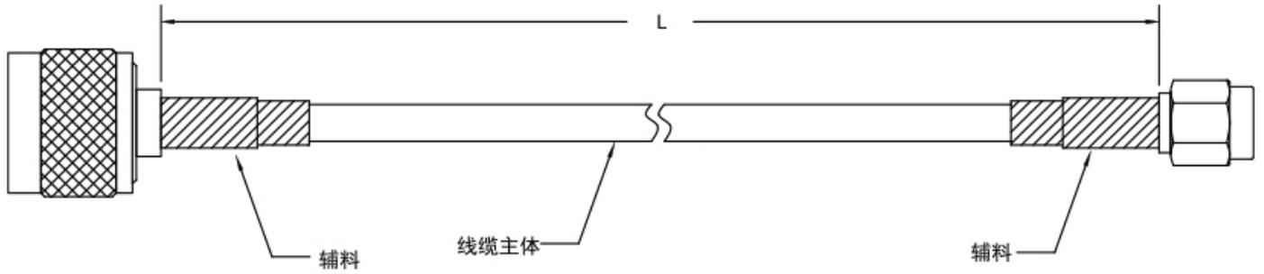
辅料：热缩套管 $\phi 7 \times 20$
